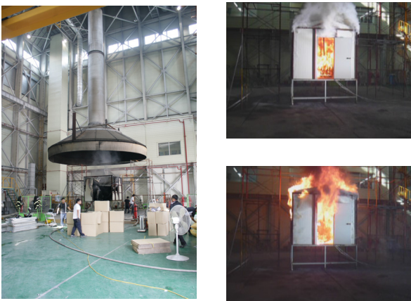
(a) 실험장치 (b) 플래시오버 전·후 그림 7 실물모형 연소실험
