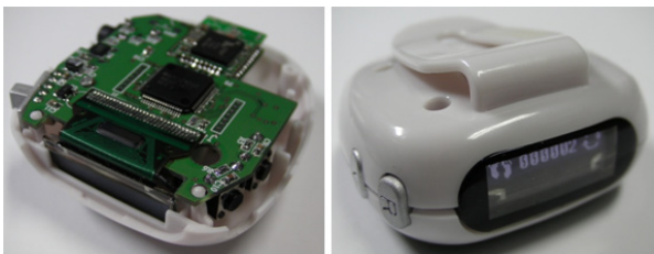
그림 5 벨트 착용형으로 제작된 낙상 검출 모듈 Fig. 5 Fall-detection module implemented in belt-clip type
