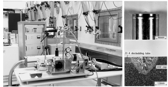
Fig. 2 핫셀용 LBW 원격챔버 및 Zr-4 봉단마개 용접단면
