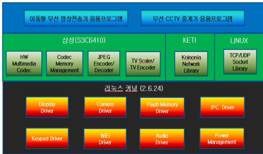
그림 6. 무선 CCTV 시스템 소프트웨어 아키텍처 Fig. 6. Software Architecture of Wireless CCTV System
