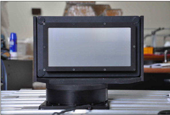
그림 5. Echelle 회절격자가 장착된 회절격자 마운트. 회절격자에서 실제 필요한 크기는 전체 길이의 2/3 정도로 크기조절로 인한 회절격자 손상을 고려하여 구입한 전체 크기를 제작된 마운트에 설치하였다.
