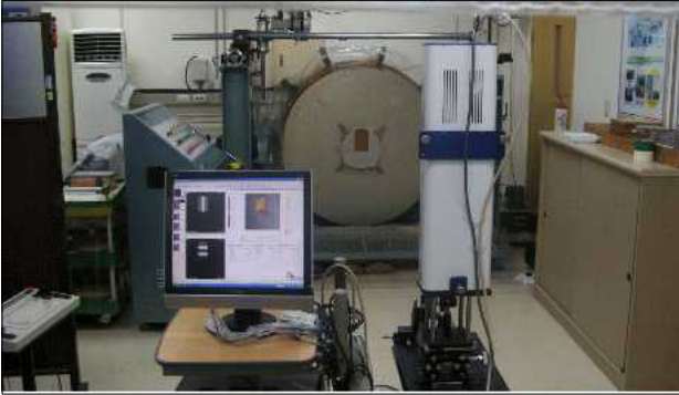
그림 3. 비축포물경의 가공 정밀도 검사 장면.
