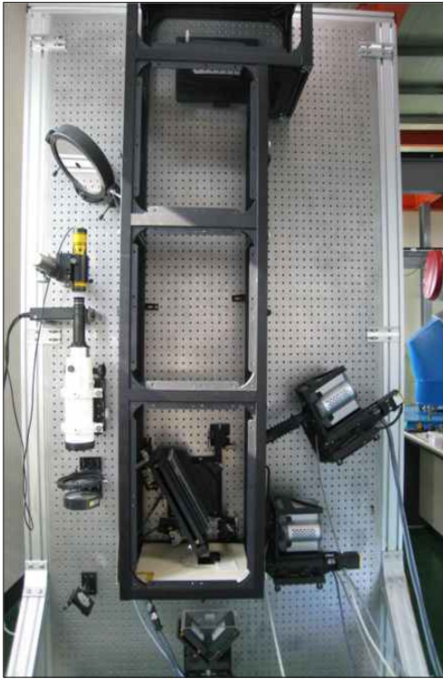
그림 13. 수직테이블에 설치한 FISS. 태양광 시험관측시, 분광기의 하우징은 먼지 및 외부 빛을 차단하기 위해 덮개 판들로 덮여진다.
