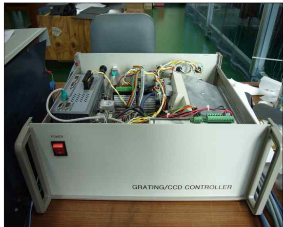
그림 9. FISS 구동부의 모터 드라이브들과 구동 컨트롤러. 드라이브들과 컨트롤러는 하나의 랙 안에 모두 장착된다.
