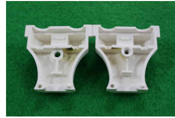
그림 10. 내부에서 탄화가 발생한 플러그 (16[A], 단선길이=5[mm], 소선수=2)
