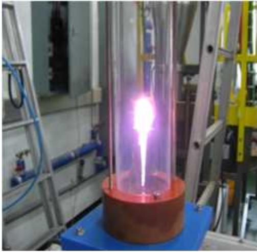
그림 2. 글라이딩 아크 플라즈마 Fig. 2. A Picture of the Gliding Arc Plasma
