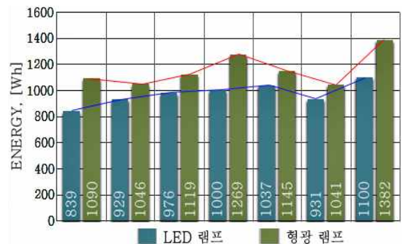
그림 16. 측정기간 조명에너지 사용 현황 Fig. 16. Lighting energy usage measurement period
