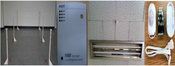
그림 2. 조도 센서와 조광용 센서 Fig. 2. Illuminance Sensor & Sensor for Dimming
