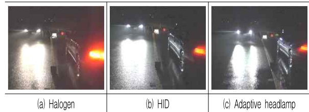
그림 14. 전조등별 노면 조사 성능 Fig. 14. Illumination performance of various headlamps : Halogen(a), HID(b) and Adaptive headlamp(c)
