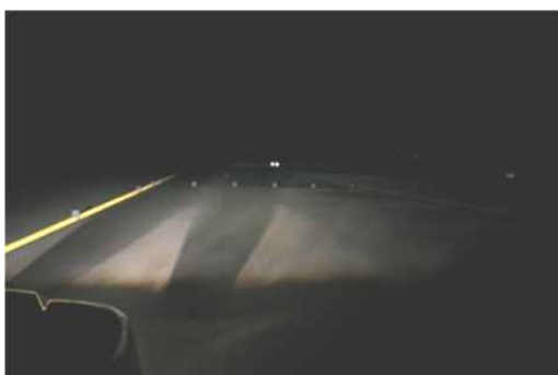
그림 6. 악천후 전조등 시제품의 배광 분포 Fig. 6. Light distribution of prototype adverse headlamp
