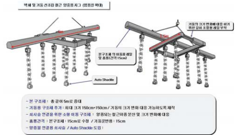
그림 8. 개발한 지그의 형태 및 주요부위의 명칭
