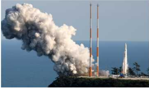
그림 1. 발사체 이륙 과정 중 화염유도로에 의해 편향된 연소 후류 가스
