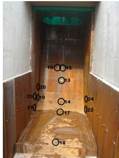
그림 4. 화염 유도로에 센서 최종 장착
