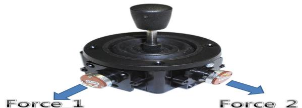
그림 1 2힘을 이용한 조이스틱
