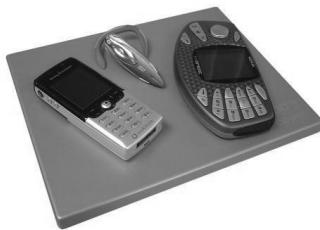
〈그림 3〉 Splash-Power Ltd.의 무선 충전패드, 여러 개의 휴대단말기를 패드위에 올려놓아 동시에 충전이 가능하다
