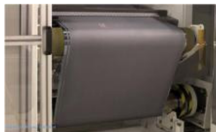
<그림 8> Nanosolar의 CIGS 박막 인쇄 공정
