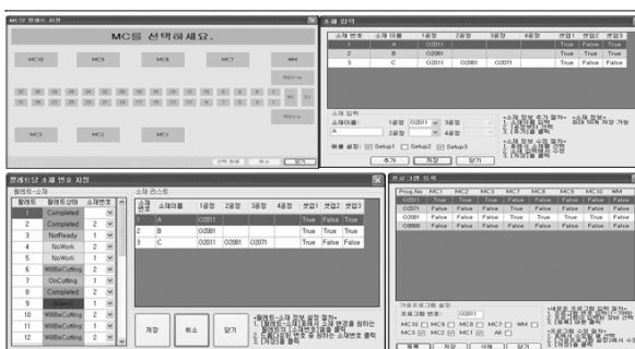
〈그림 6〉 운영소프트웨어 설정화면: MC당 팔레트 지정(좌상), 소재등록(우상), 팔레트당 소재 지정(좌하), MC별 가공프로그램 등록(우하)
