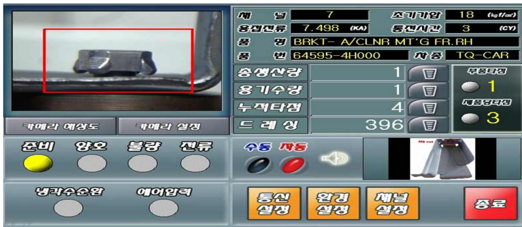
그림 6. 스포트 용접시스템에서의 영상분석을 위한 화면구성도
