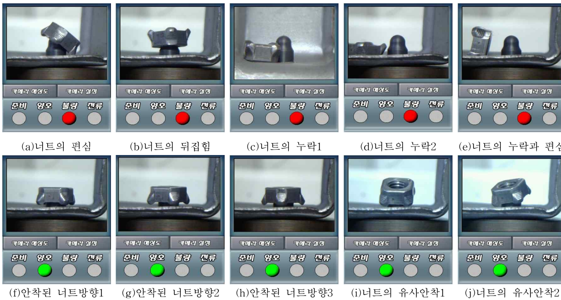
그림 7. 너트 체크시트에 따라 진행된 시뮬레이션 결과화면
