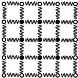
그림 1. 이미지 모핑을 위한 질량-스프링 시스템 구조
