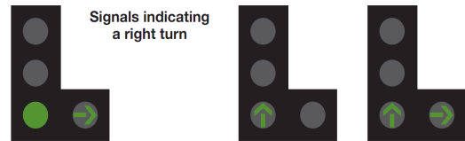
〈그림 5〉 우회전 신호등이 설치된 사례
