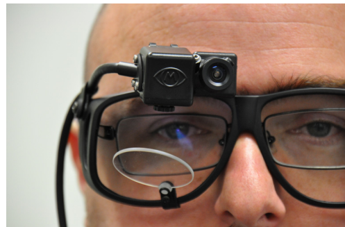
〈그림 5〉 연구에 사용된 안구추적 시스템 (ASL Mobile Eye)
