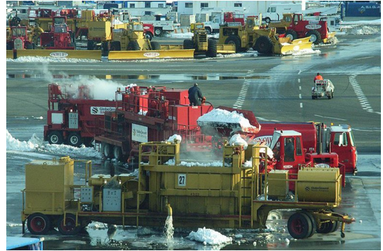
〈그림 2〉 미국 JFK 공항 활주로 제설작업 용 snow melter (2006)
