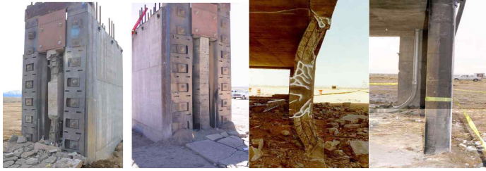
그림 5. FRP 보강 유·무에 따른 폭발저항성
