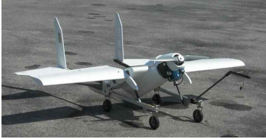
Fig. 1 자유날개 동체꺾임형 항공기 (Scorpion 40% flight model)
