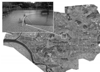
그림 7. 사진기준점측량에 사용한 지상기준점 배치도
