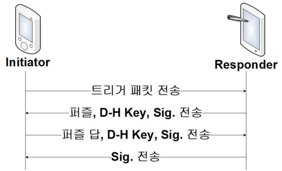
그림 4. HIP Association 의 기본 과정 Fig. 4. Basic Procedure of the HIP Association.
