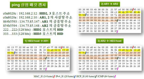
그림 17. PING 패킷 분석 Fig. 17. PING packet analysis.
