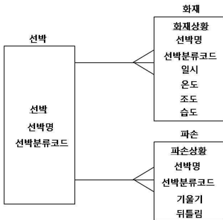
그림 8. 데이터 개체 관계도 Fig. 8. Data Entity Relationship Diagram.
