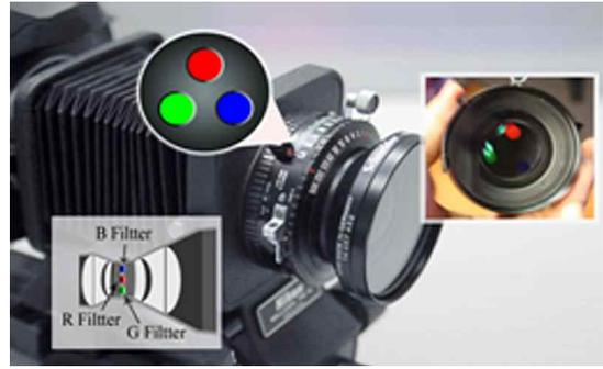
그림 2. 다중 컬러 필터 조리개를 사용한 계산 카메라 구성
