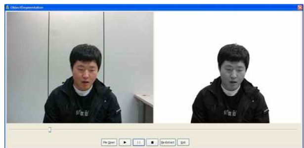
그림 15. 데모 시스템의 스크린 샷. 모든 과정은 자동적이고 실시간으로 수행된다. (a) 원 영상 (b) 추출된 객체 Fig. 15. Screen shots of our demo system. All process is automatic and operated in real-time. (a) original frame (b) extracted object.
