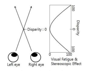
그림 2. 인간 시각계에서의 거리에 따른 사용자 피로도 관계(X축과 Y축의 값은 상대적인 크기를 표시) Fig. 2. Visual Fatigue in Human Visual System (Values in X and Y axis are relative numbers).
