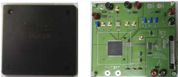
그림 11. 제작된 칩과 PCB Fig. 11. Packaged chip and PCB for Measurement.
