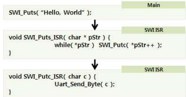
그림 7. 중 소프트웨어 인터럽트 Fig. 7. Simple sequence of SWI Nested Call.
