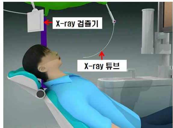
그림 3. 신개념 치근단 촬영장치의 개략도 Fig. 3. Schematic diagram of periapical radiography with new concept.
