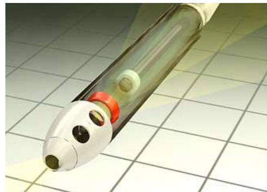
그림 4. 신개념 치근단 촬영장치의 X-선 콜리메이터 Fig. 4. X-ray collimator of periapical radiography with new concept.
