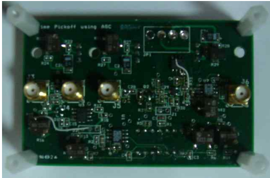
그림 8. 제안된 time pickoff 회로 사진 Fig. 8. Photograph of the proposed time pickoff circuit.
