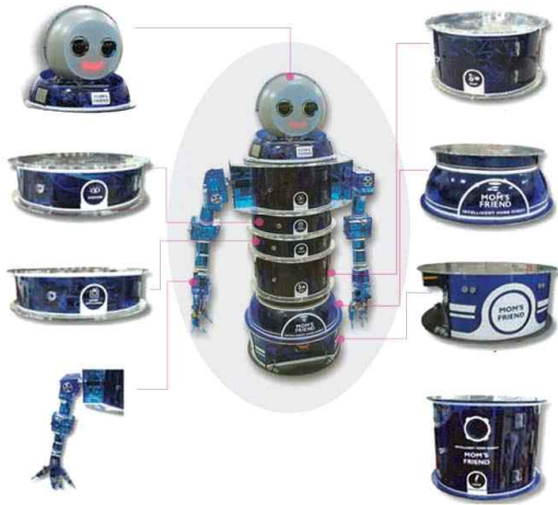
그림 8. 모듈화 로봇 시스템 'MF' [14] Fig. 8. Modular Robot System 'MF' [14]
