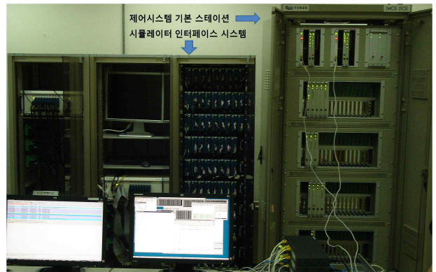
그림 7 기능시험 환경인 시뮬레이터 I/O 인터페이스 시스템과 제어 시스템 Fig. 7. Simulator interface system and control system as functional test environment.
