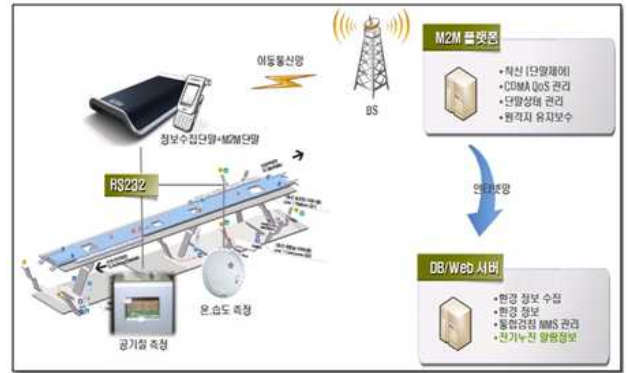
그림 10. M2M CDMA 무선통신을 이용한 모니터링 시스템 Fig. 10. Monitoring system using M2M CDMA wireless communication.
