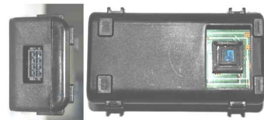
그림 12. 제작된 우적감지센서 Fig. 12. Fabricated rain sensor.
