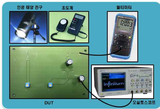
그림 12. 테스트보드 및 측정환경 Fig. 12. Test board and measurement setup.
