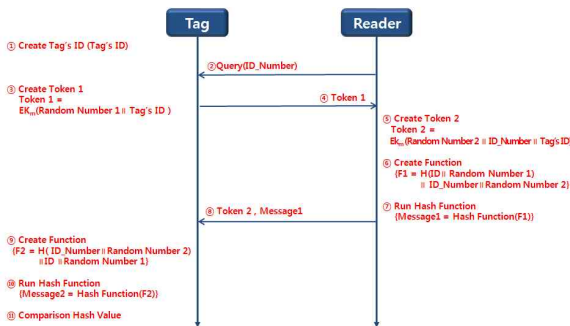
그림 3. 태그와 리더 인증과정 Fig. 3. Tag and Reader's Certification Process.
