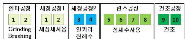
그림 3. 연마과정이 포함된 세정 시스템 Fig. 3. The cleaning system including a grinding process.
