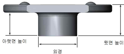
그림 6. T형 용접너트의 검사항목(측면) Fig. 6. Inspection factor of T type welding nut (Side).
