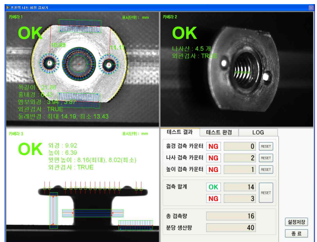
그림 3. T형 용접너트의 비전 검사기의 사용자 인터페이스 Fig. 3 User interface of T type welding nut vision inspector.
