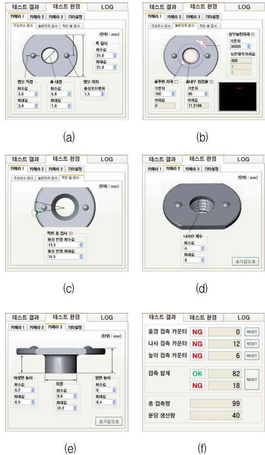
그림 8. 측정 항목 설정 및 측정 결과 표시 창 (a) 너트 상부 치수 검사항목 설정 창 (b) 너트 상부 얼룩 검사항목 설정 창 (c) 너트 상부 찌힌 홈 검사항목 설정 창 (d) 너트 나사산 개수 검사항목 설정 창 (e) 너트 측면부 치수검사항목 설정 창 (f) 비전검사 결과 정보 표시 창
