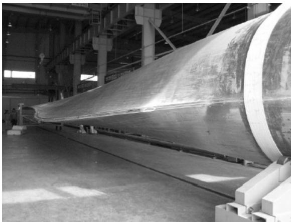
그림 5 복합소재 풍력발전 날개부 제작 예(길이 44m, 중량 10.6ton)
