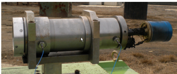
Fig. 6. 점화제 파우더 사용시 미발사된 모습
