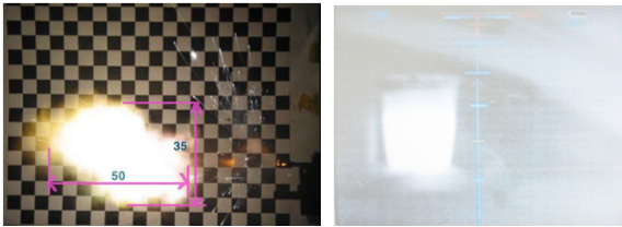
Fig. 1. 총열 단산화 설계에 따른 불완전 연소를 화염 저감형 소염기로 제어
