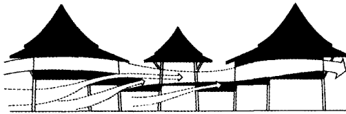
<그림 6> 단차를 이용한 통풍 흐름 출처: Wattana Boonjub(2009), Silpakorn univ., p.10 재정리
