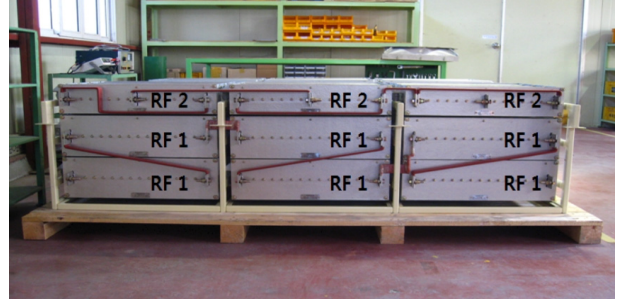
그림 2 격자저항기 완제품 Fig. 2 Motor block resistor assembly
