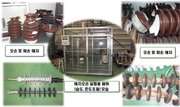
그림 3 오손 파손 예자 및 시험용 챔버 Fig. 3 Fail insulator and test chamber
