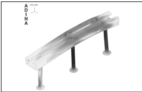
Fig. 7(b) Channel Unit의 유한요소해석 결과 ( em=125mm인 경우 )
