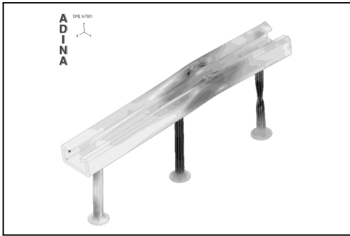
Fig. 7(a) Channel Unit의 유한요소해석 결과 ( em=75mm인 경우 )
