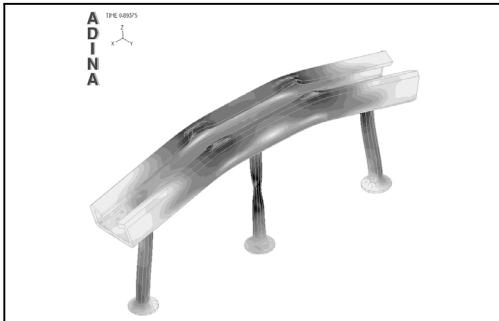
Fig. 7(c) Channel Unit의 유한요소해석 결과 ( em=175mm인 경우 )
