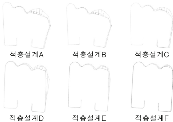
Fig. 22 원통형 추와 충돌 후 단면의 변형 형상
