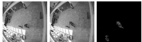
그림 2. SAD를 이용한 움직임 벡터 검출 Fig. 2. Motion Vector Detection using SAD
