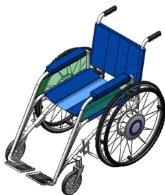
그림 6. 힘 보조형 전동 휠체어 시뮬레이션 모델 Fig. 6. Simulation model of power assisted electric wheelchair
